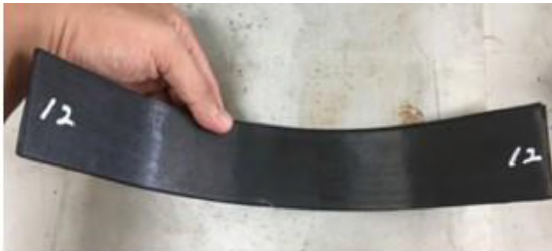
Рисунок 1 – Элемент шасси БПЛА из углепластика [1]
