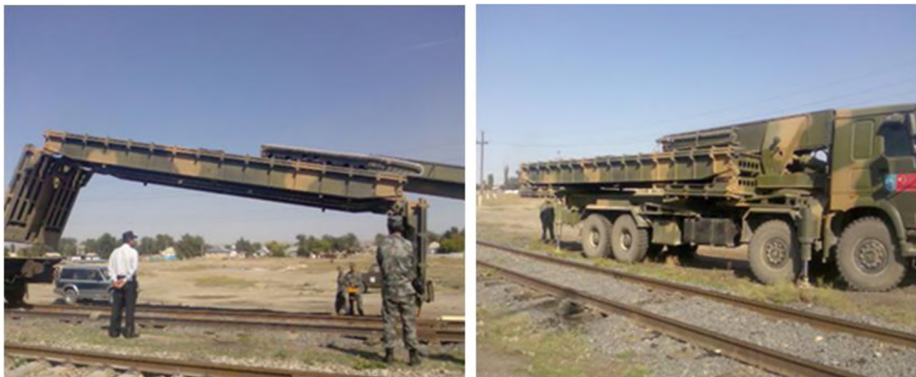
Рисунок 1 – Передвижная погрузочно-выгрузочная платформа на автомобильном ходу (КНР)
