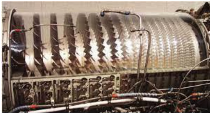
Рисунок 3 – Лопатки вентилятора из боропластик авиадвигателе J-79[9]
