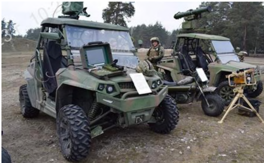
Рисунок 3 – Багги с установленным на крыше ПТУР (ВСУ)
