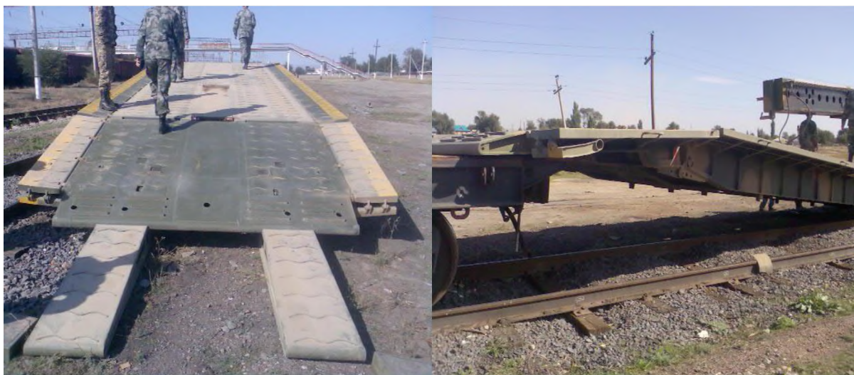
Рисунок 2 – Передвижная погрузочно-выгрузочная платформа на автомобильном ходу в развернутом состоянии (КНР)
