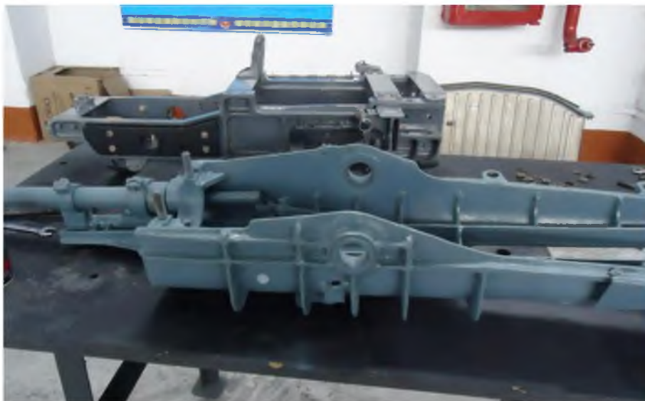
Рисунок 2 – Лафета артиллерийской установки ГШ-23Л
