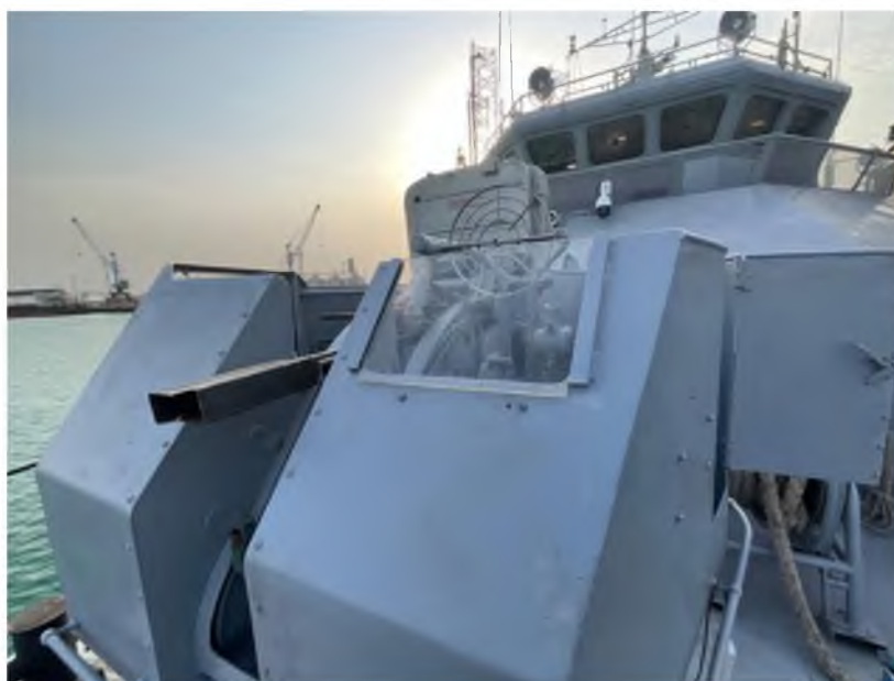
Рисунок 8 – Защитное окно и пламегаситель пороховых газов
