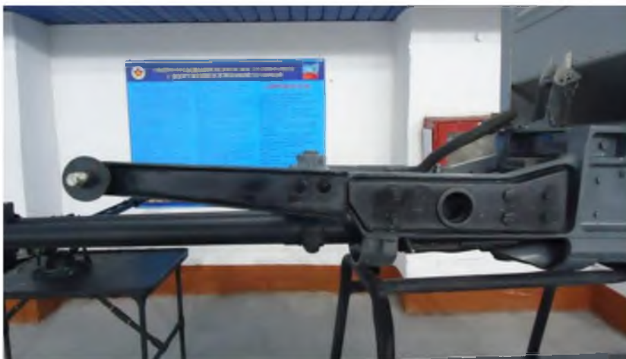
Рисунок 3 – Кронштейн крепления прицела
