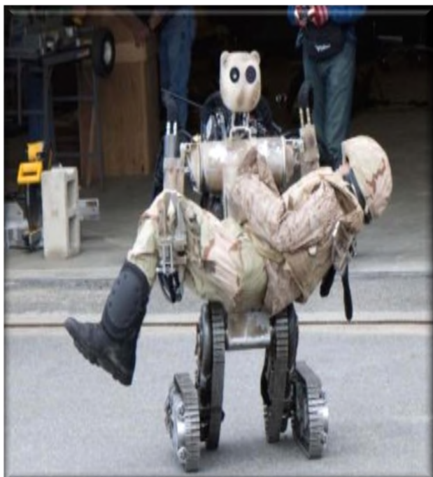
Рисунок 3 – Эвакуация раненого и тяжелых предметов роботом (BEAR) [3]
