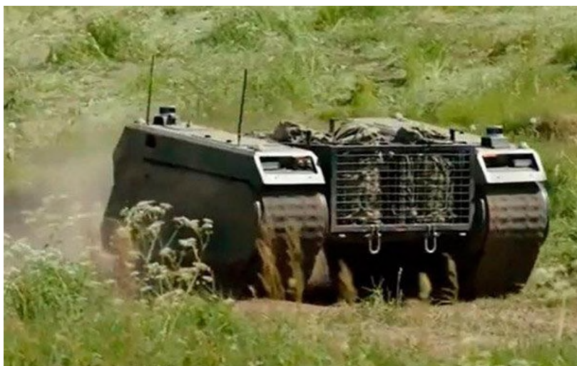
Рисунок 4 – Беспилотная тележка на гусеницах для подвоза боекомплекта и эвакуации раненых (фото из открытых источников)
