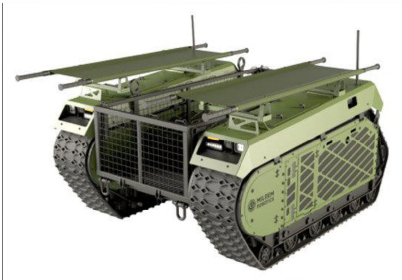
Рисунок 3 – Беспилотная тележка-робот на гусеничном ходу, с закреплёнными двумя лежачими местами для раненых (фото из открытых источников)
